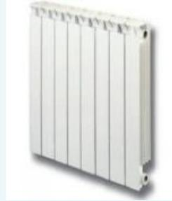
Scaldano l'ambiente grazie al fluido scaldante che, proveniente dalla caldaia, cede calore all'ambiente attraverso le pareti dei radiatori stessi. La temperatura normale di esercizio prevede l'ingresso dell'acqua (dall'alto) a 60-80°C e una differenza in uscita di 10°C. Lo scambio di calore avviene in piccola parte per irraggiamento (30%) ed in quantità consistente per convezione (70%). Quelli in alluminio hanno un costo contenuto, sono leggeri e caratterizzati da una bassissima inerzia termica.
