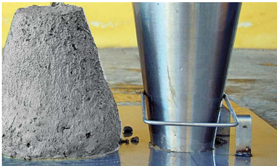
Figura 1 - Cono di Abrams, modello semplice e misurazione rovesciando il cono
